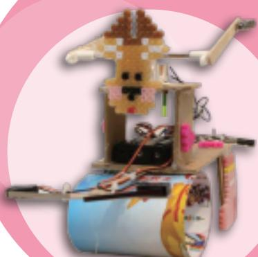
藉前臂旋轉的慣性作用力，以及前端寶特瓶的彈力效果，讓晃動效果放大，使機器戰鼠看起來像是在跳動的樣子，而整體所呈現的效果更像是正奮力地在挖土。
